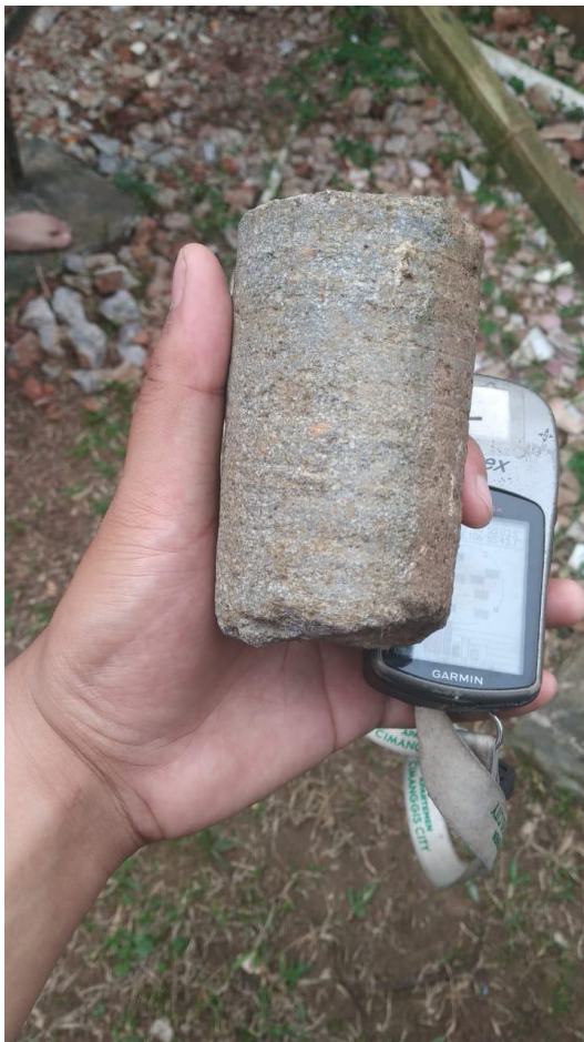
Gambar 14. Sampel boring andesit pada pemboran sebelumnya
