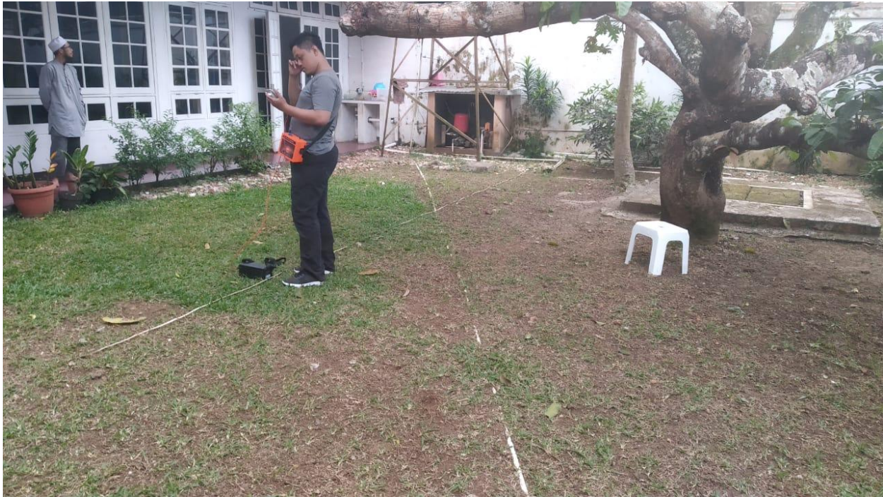
Gambar 16. Pengukuran resistivitas oleh surveyor di lokasi belakang ponpes
