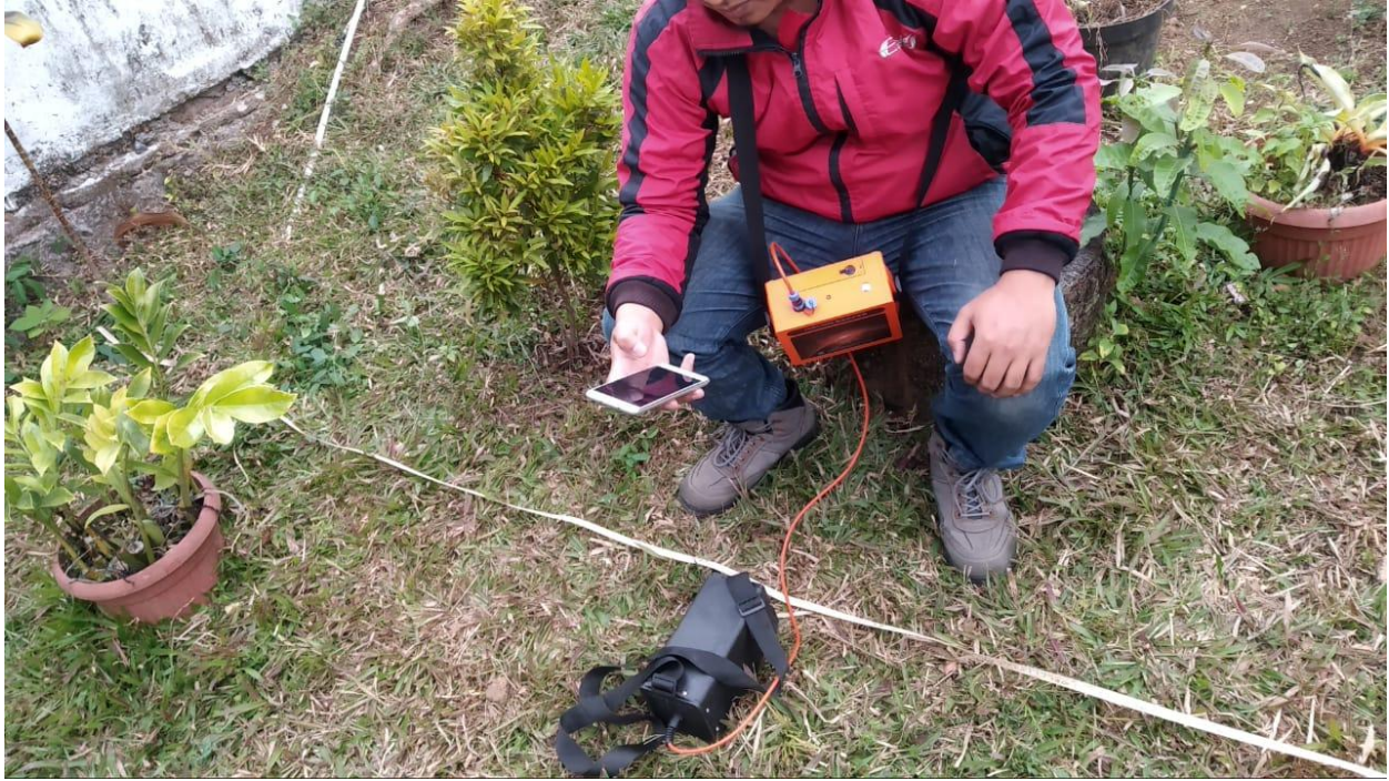
Gambar 19. Pengukuran geolistrik dibagian depan ponpes oleh surveyor
