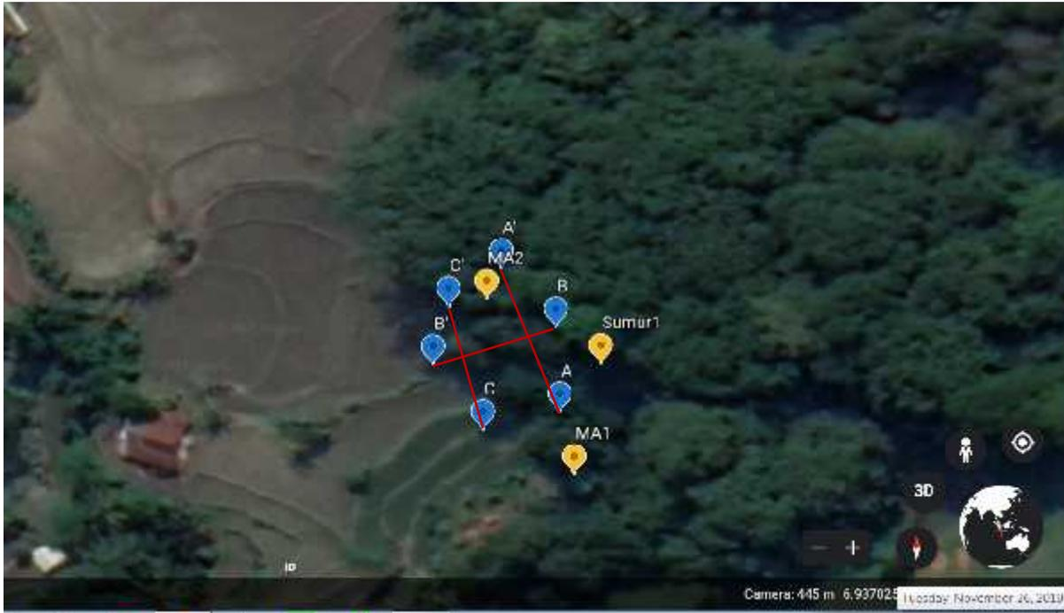
**Gambar 3.** Lintasan pengukuran resistivitas pada Desa Caringin Pelabuhan Ratu
