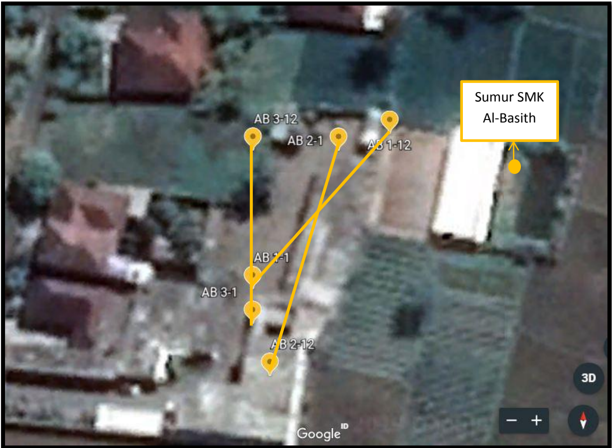
Gambar 2.2 Desain Lintasan Pengukuran Tahanan Jenis SMK Al-Basith.
