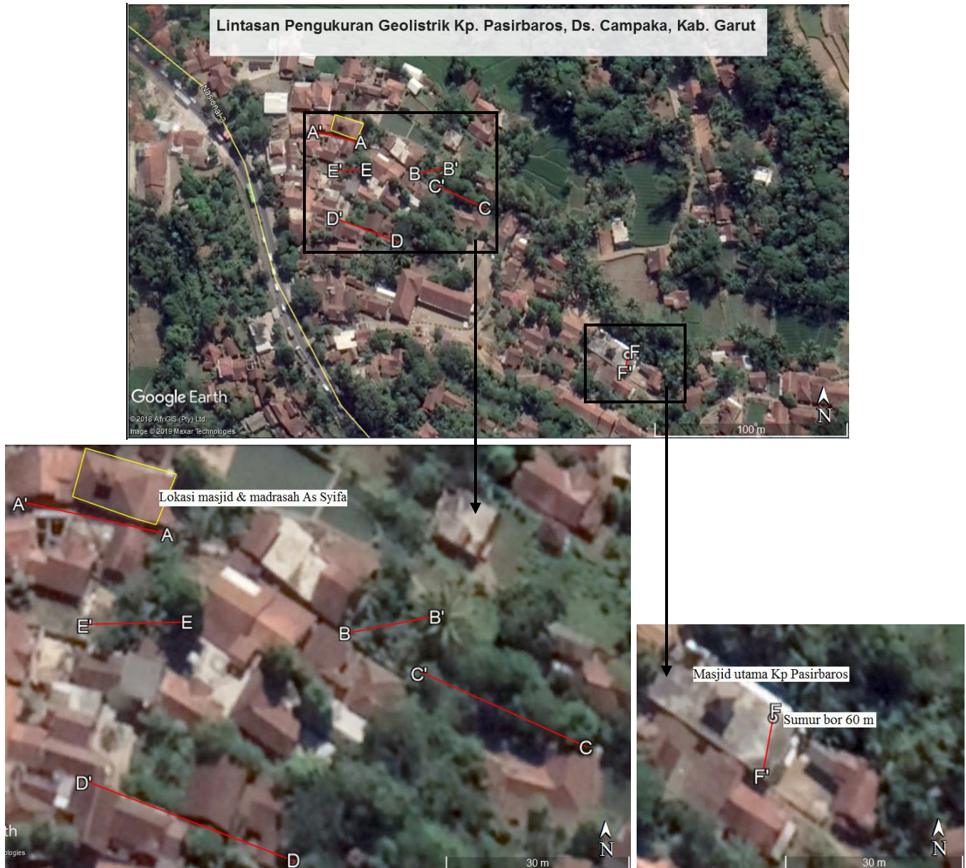
Gambar 3. Teknis pengukuran geolistrik pada lokasi masjid & madrasah As Syifa.
