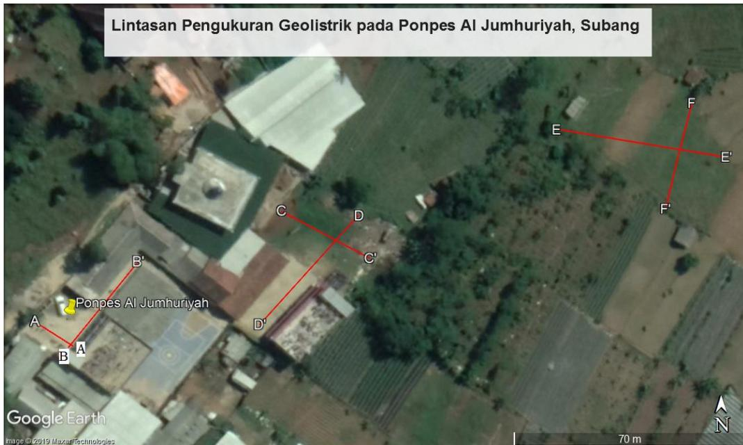
**Gambar 3.** Lintasan pengukuran geolistrik pada ponpes Al Jumhuriyah.
