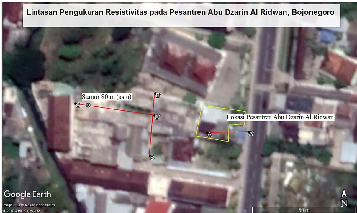
Gambar 3. Teknis survey resistivitas pada Pondok Pesantren Abu Dzarir Al Ridwan.
