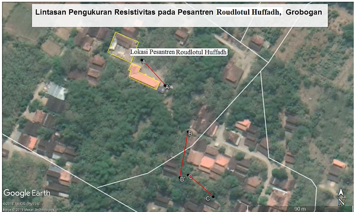
Gambar 3. Teknis survey resistivitas pada Pondok Pesantren Roudlotul Huffadh.
